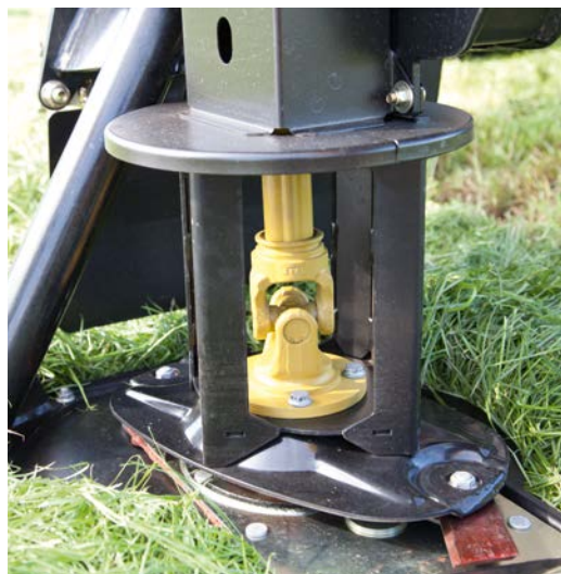
Antrieb von oben direkt in die erste Mäh Scheibe
